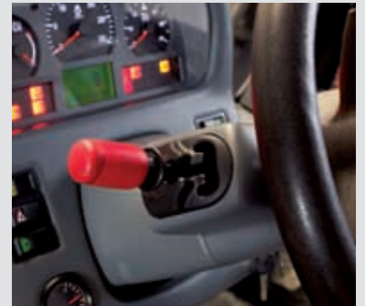
Inversore PowerShuttle con il freno di stazionamento integrato
