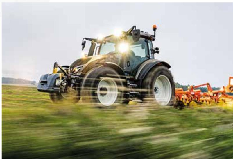
In quanto produttrice di trattori Valtra con 70 anni di esperienza, i motori compatti AgcoPower offrono grandi caratteristiche di potenza e coppia. Il motore compatto da 4,4 litri con dimensioni ridotte, consente un cofano ribassato con grande visibilità. Il sistema di post-trattamento del motore all-in-one pulisce lo scarico secondo
