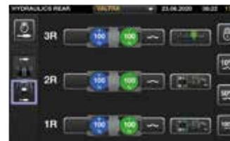
È possibile assegnare qualsiasi controllo per azionare qualsiasi funzione idraulica, comprese le valvole idrauliche anteriori e posteriori, i collegamenti anteriori e posteriori e il caricatore frontale.
