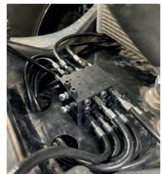
Assale anteriore e sollevatore anteriore della serie S sistema di lubrificazione centrale del sollevatore.
