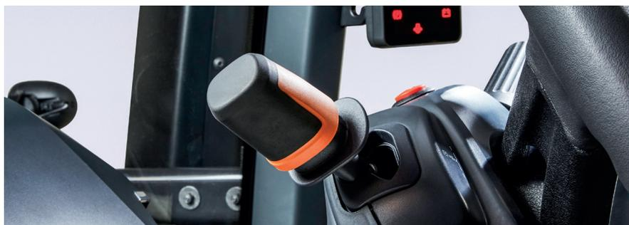
**Freno di stazionamento integrato /** Il freno di stazionamento completamente integrato e di facile impiego, riduce lo stress e i movimenti superflui della mano durante il lavoro del caricatore. Posizionato perfettamente dietro il volante, è facile da raggiungere.
