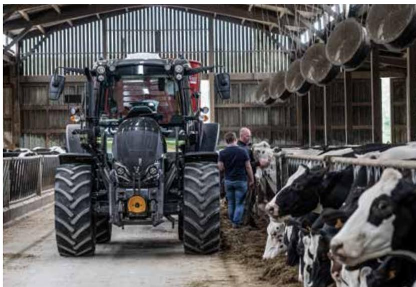
I tre modelli più piccoli hanno motori a tre cilindri da 3,3 litri, mentre i due modelli più grandi hanno motori a quattro cilindri da 4,4 litri. Questi motori di facile utilizzo sono dotati di tecnologie all'avanguardia, come l'iniezione common rail a 1600 bar e
