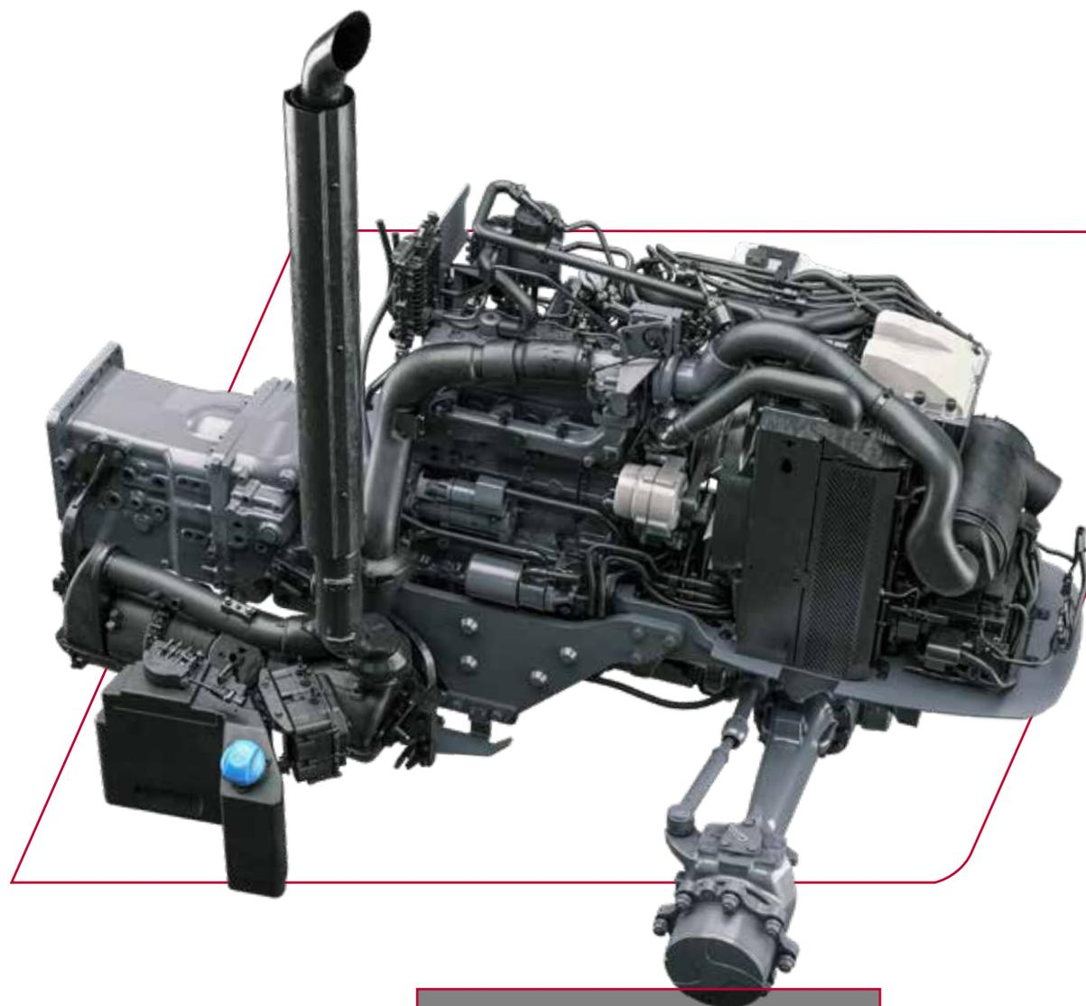
Stage V è situata sotto la cabina per una visibilità ottimale. Il pacchetto completo comprende DOC, DPF e SCR con AdBlue e, poiché non c'è ricircolo dei gas di scarico (EGR), il motore utilizza sempre aria fresca e pulita.
