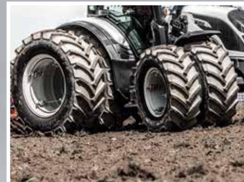
**ASR:** minore slittamento, maggiore aderenza. Il nuovo rivoluzionario regolatore antislittamento automatico (ASR o Acceleration Slip Regulator) gestisce automaticamente lo slittamento delle ruote per migliorare la presa durante le operazioni di trazione, ottimizzando in modo significativo il risparmio di carburante. Questa funzione completa il sistema a 4RM e bloccaggio automatico del differenziale, oltre che il tradizionale controllo antislittamento AutoControl nei modelli Versu e Direct.
