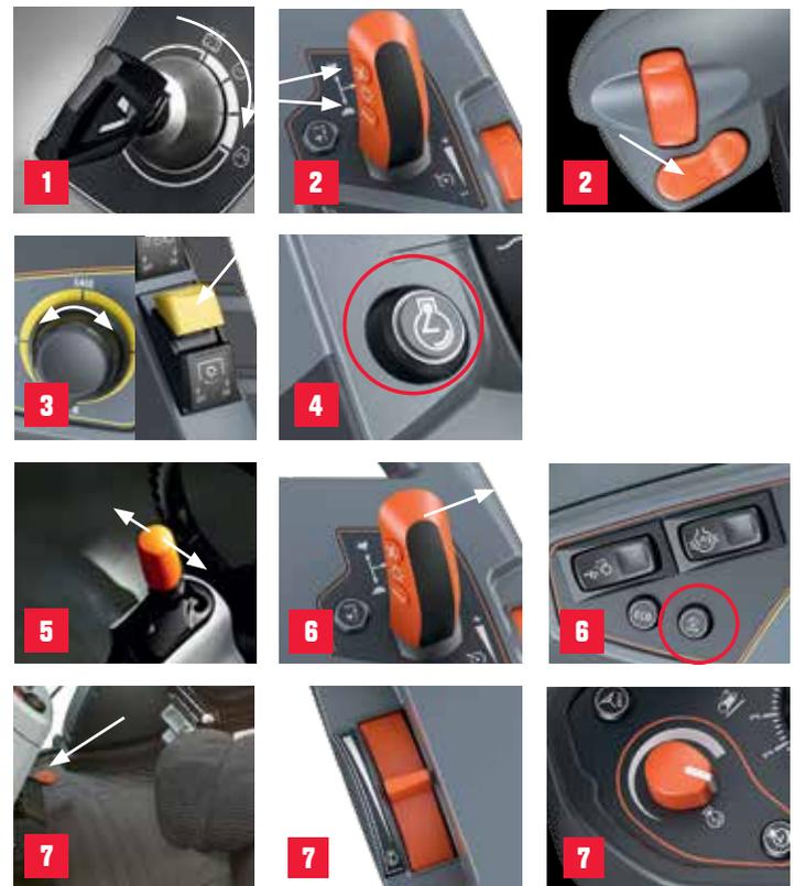
**NOTA:** uso stazionario della PTO. Se la PTO è in funzione e ci si alza da sedile del conducente, il sensore di presenza dell'operatore normalmente arresta la presa di forza. Per evitare questo, tenere l'interruttore della PTO in posizione di avvio ON per tre secondi prima di alzarci dal sedile di guida (la presa di forza deve essere già avviata quando si esegue questa operazione)
