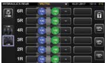
È possibile assegnare qualsiasi comando per azionare le funzioni idrauliche, comprese le valvole idrauliche anteriori e posteriori, i sollevatori anteriori e posteriori e il caricatore frontale.
