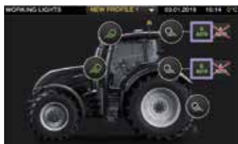
La configurazione delle luci di lavoro risulta semplice grazie allo schermo a sfioramento da 9". Nel bracciolo ci sono anche pulsanti on/off per le luci e i fari di lavoro.
