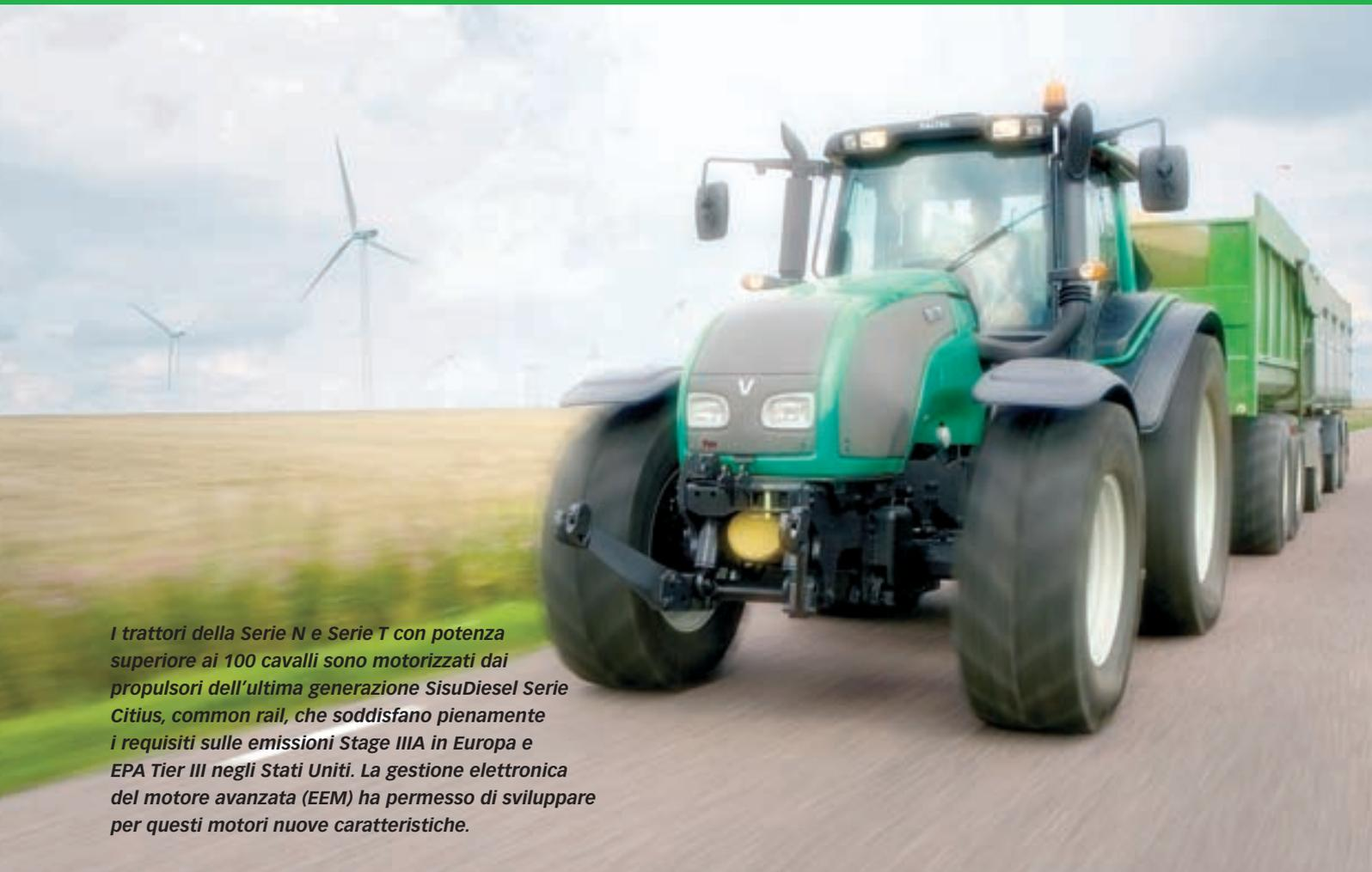
*I trattori della Serie N e Serie T con potenza superiore ai 100 cavalli sono motorizzati dai propulsori dell'ultima generazione SisuDiesel Serie Citius, common rail, che soddisfano pienamente i requisiti sulle emissioni Stage IIIA in Europa e EPA Tier III negli Stati Uniti. La gestione elettronica del motore avanzata (EEM) ha permesso di sviluppare per questi motori nuove caratteristiche.*
