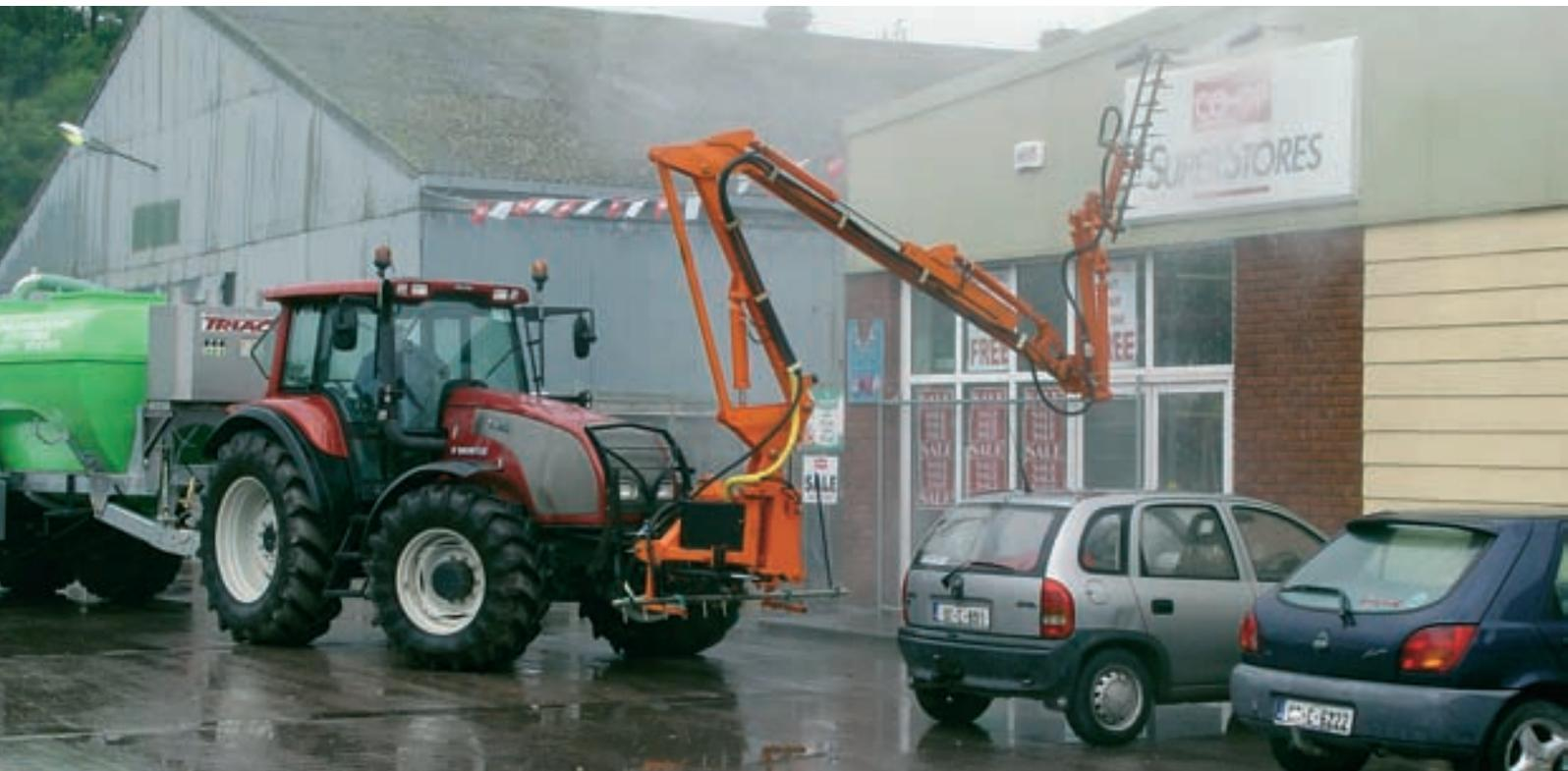
*Il braccio motorizzato può essere utilizzato per sollevare la testata dell'idropulitrice sopra gli ostacoli.*
