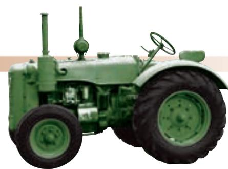
schizzinoso in materia di carburante. L'idea dell'inventore era quella di produrre un motore che lavorasse con un basso rapporto di compressione di 6:25:1, che potesse essere usato con carburanti che gassificano male.
