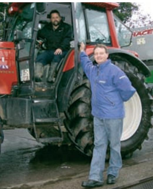
John. "Dato che i vari luoghi di lavoro possono essere distanti tra loro abbiamo optato per una trasmissione a 50 kmh, per la sospensione del ponte anteriore, e ovviamente per la frenatura del rimorchio poiché rimorchio e attrezzatura pesano 23,8 tonnellate. Al lavoro dobbiamo muoverci poi molto lentamente con le marce ridotte per mantenere la velocità alla PTO, di qui la scelta di un Valtra – ovviamente considerato anche il prezzo concorrenziale."
