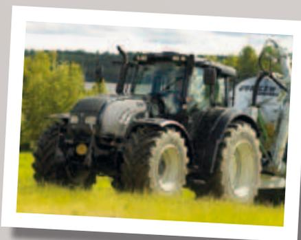
Valtra 202 equipaggiato con una moderna trasmissione Cvt, ribattezzata Direct, che costituisce una combinazione di componenti meccaniche e idrauliche.
