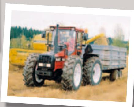
Il Valmet H800 adottava una trasmissione totalmente idrostatica, senza componenti meccaniche.
