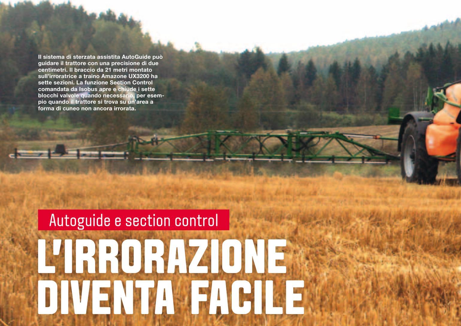
Il sistema di sterzata assistita AutoGuide può guidare il trattore con una precisione di due centimetri. Il braccio da 21 metri montato sull'irroratrice a traino Amazone UX3200 ha sette sezioni. La funzione Section Control comandata da Isobus apre e chiude i sette blocchi valvole quando necessario, per esempio quando il trattore si trova su un'area a forma di cuneo non ancora irrorata.
