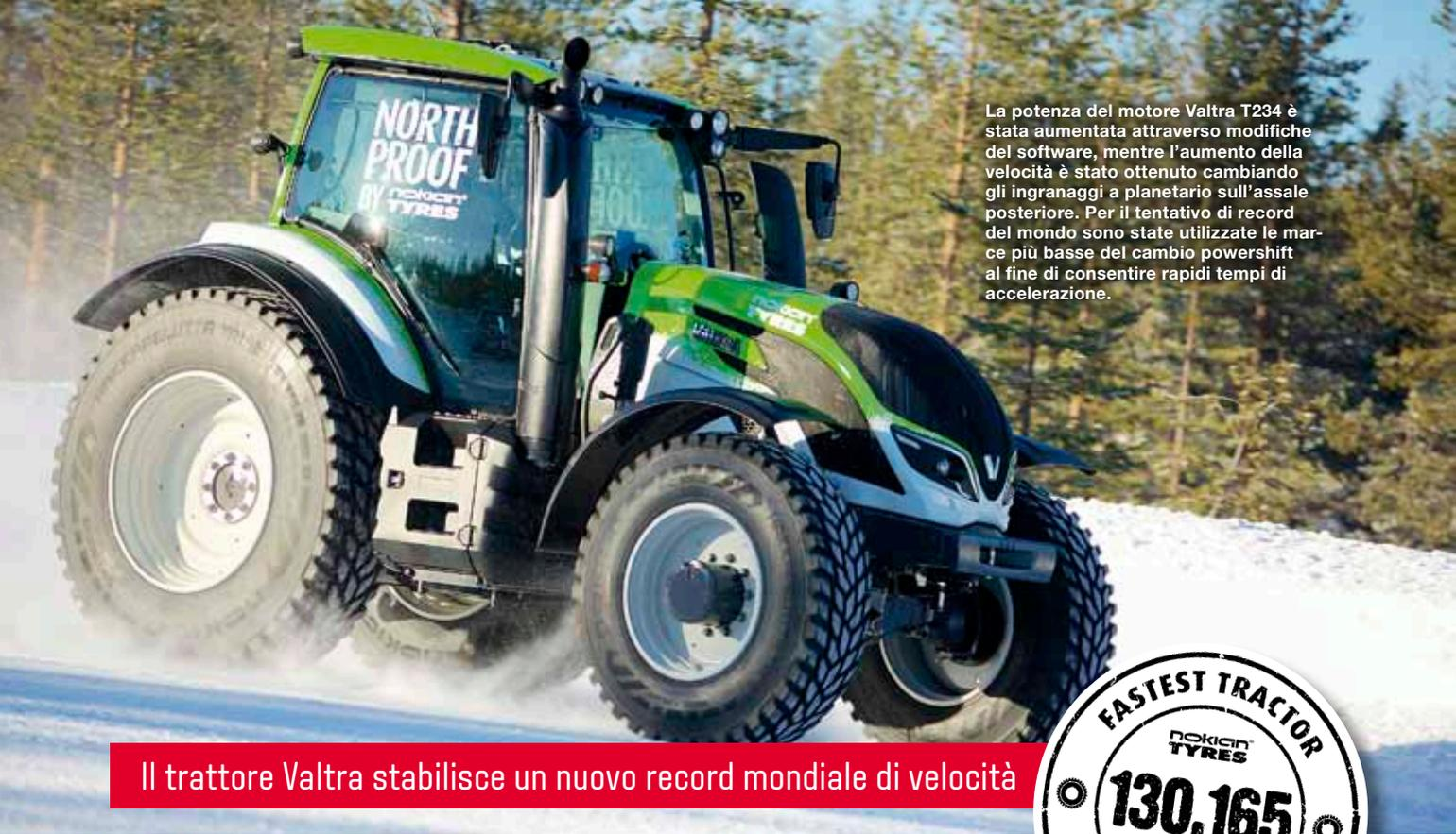
La potenza del motore Valtra T234 è stata aumentata attraverso modifiche del software, mentre l'aumento della velocità è stato ottenuto cambiando gli ingranaggi a planetario sull'assale posteriore. Per il tentativo di record del mondo sono state utilizzate le marce più basse del cambio powershift al fine di consentire rapidi tempi di accelerazione.
