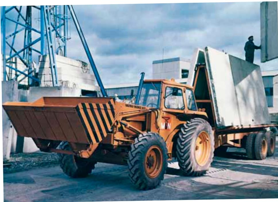
Il Valmet 1100-4 era una macchina superba nel 1969: 4 ruote motrici, motore turbo 4 cilindri e 115 cv.
