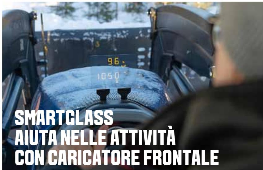
**I**l display del parabrezza SmartGlass, presentato ad Agritechnica, ha ricevuto molti feedback positivi nei test effettuati con gli utenti. SmartGlass è utile nelle attività con il caricatore frontale, ma anche nelle attività di trasporto e sul campo poiché il conducente non deve più guardare i quadranti in basso. Il conducente può inoltre decidere quali informazioni visualizzare sulle due righe informative di SmartGlass.
