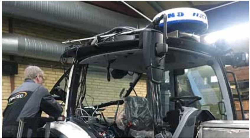
La Valtra N154 è una macchina multiuso che può essere dotata di una vasta gamma di strumenti, tra cui un radar marittimo, una termo camera a infrarossi e un riflettore di ricerca.
