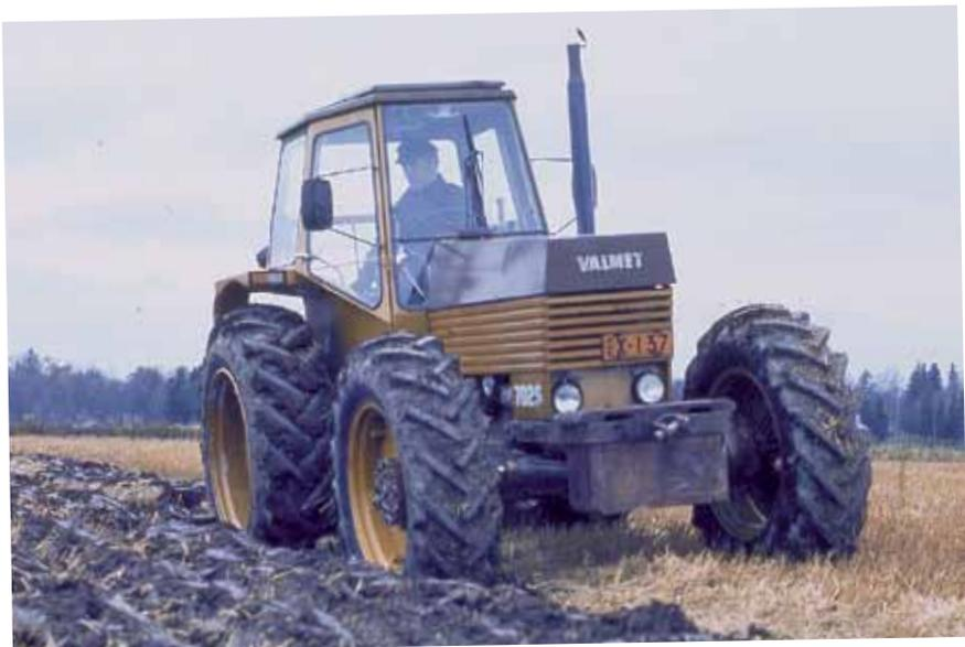
702S può essere identificato dal suo cofano più alto per ospitare il turbocompressore. La trazione integrale ha ampliato la gamma di compiti, anche se ha aumentato il raggio di sterzata. Secondo un rapporto di prova del Vakola (State Agricultural Machinery Research Institute) nel 1978, il Valmet 702S offriva buone prestazioni con le sue attrezzature standard.
