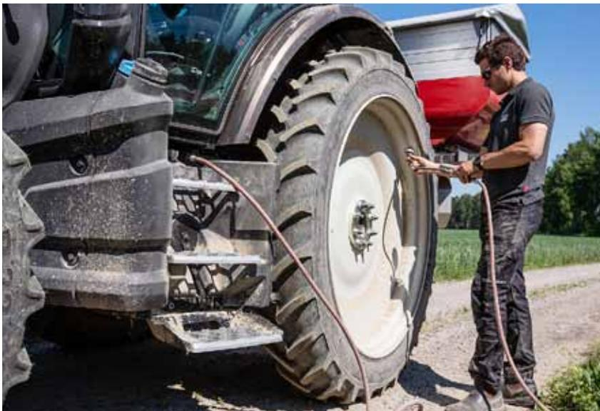
La nuova serie G è disponibile con un connettore per aria compressa sul lato del trattore vicino ai gradini della cabina, facilitando ad esempio la regolazione della pressione dei pneumatici.
