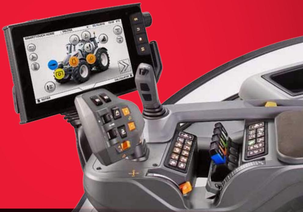
SmartTouch Extend consente ai trattori con SmartTouch di controllare contemporaneamente l'attrezzo ISOBUS su uno schermo e lo sterzo automatizzato Valtra Guide sull'altro, ad esempio.
